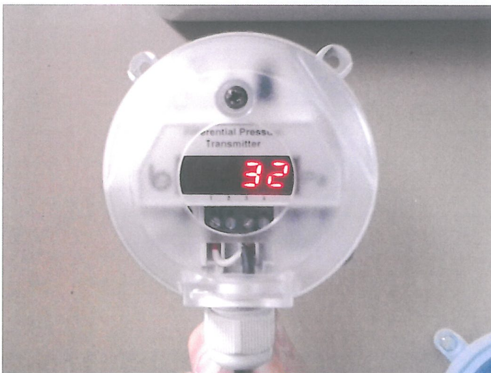
Fotografia del trasmettitore di pressione differenziale modello “984.323314” durante la prova.
