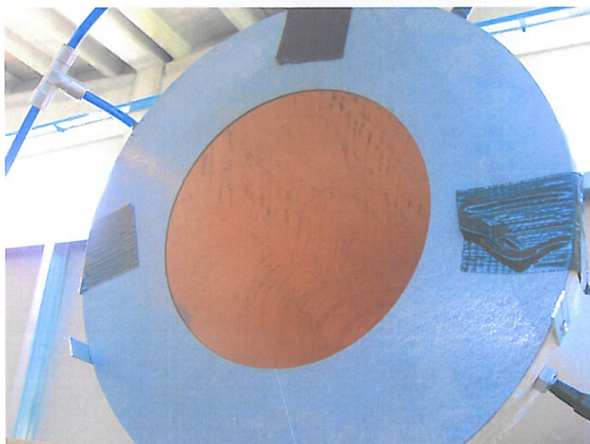
Fotografia della flangia di riduzione del canale d'aspirazione.
