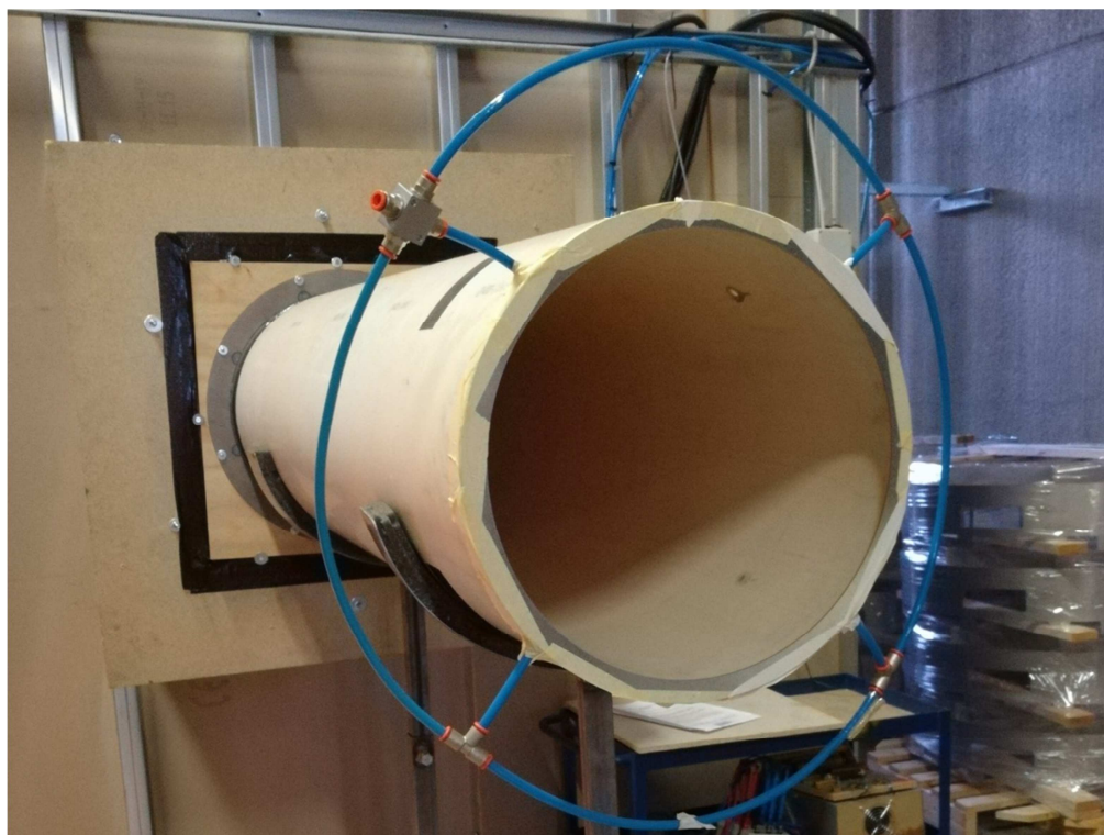
Fotografia della flangia di riduzione posta all'estremità del canale d'aspirazione
